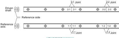
Fig 1.11.3 Butt-joint
